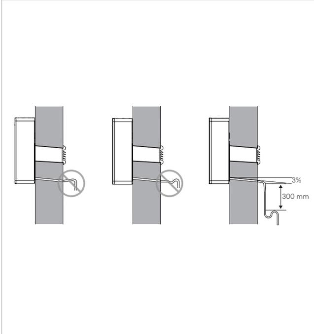
⚠ Le système d'écoulement doit prévoir un siphon adéquat afin de prévenir la pénétration involontaire d'air dans le système de dépression. De plus, le siphon empêche la pénétration d'odeurs ou d'insectes.
